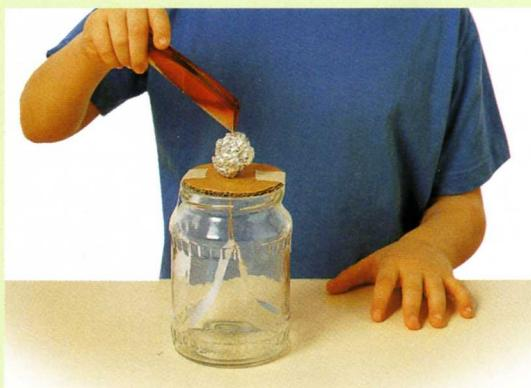
**5** Потри пластмассовой расчёской пять – десять раз о свитер или о волосы. Медленно поднеси заряженную расчёску к шарику из фольги на крышки электроскопа. Оба конца фольги поднимутся. Чем ближе расчёска, тем выше они поднимаются.
