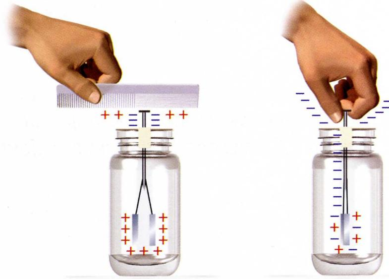
▲ Отрицательные заряды притягиваются к шарику из фольги положительными зарядами расчёски. Теперь обе полоски фольги заряжены положительно и расходятся в разные стороны. Если нажать на шарик из фольги, отрицательные заряды вернут их в прежнее положение.
