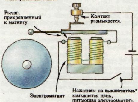
Нажмем на выключатель\* замыкается цепь, питающая электромагнит.
