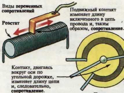
Подвижный контакт изменяет длину включенного в цепь провода и, таким образом, сопротивление.
