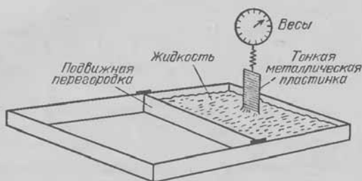
Рис. 56. Устройство для непрерывного измерения коэффициента поверхностного натяжения жидкости и его зависимости от площади ее поверхности.
