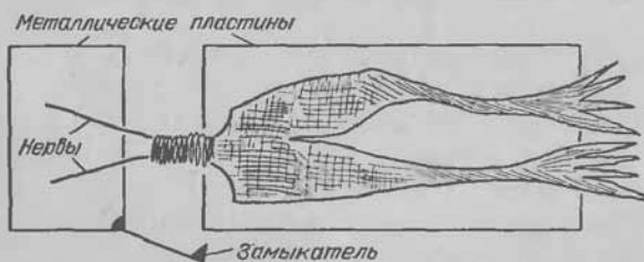
Рис. 1. Схема опыта Л. Гальвани, анализ которого привел А. Вольта к изобретению источника постоянного тока
