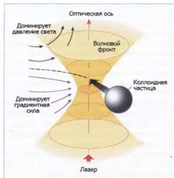
Рис. 1. «Захват» коллоидной частицы оптическим пинцетом
