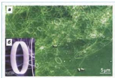
Рис. 3. а — Общий вид нанокольц ZnO, б — морфология монокристаллического нанокольца ZnO с однородной идеальной геометрической формой
