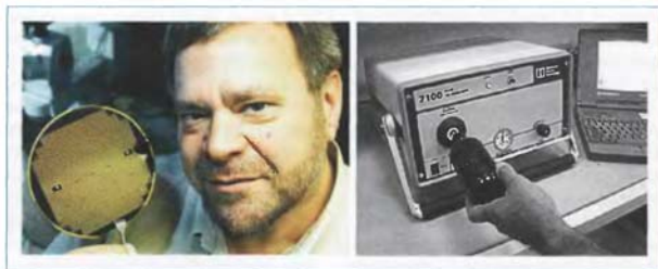
Рис. 1. Чип-пластина «электронного носа» из 2200 ячеек-анализаторов Sensation, университет Беркли, США (слева). Быстрый газовый хроматограф GC/SAW лабораторного типа (справа)
