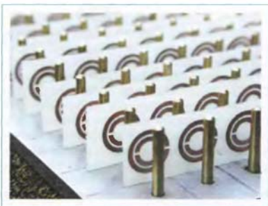
Рис. 1. Фотография метаматериала с отрицательным показателем преломления для микроволнового излучения
