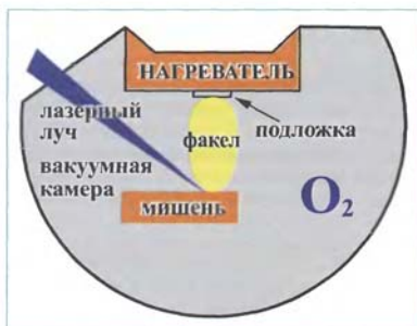
Рис. 1. Схема метода лазерной абляции для нанесения тонких пленок
