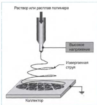
Рис. 1. Схематическое представление процесса электроспиннинга
