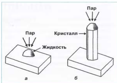
Рис. 3. Схематическое представление основных этапов роста кристаллов по механизму «пар — жидкость — кристалл»: а — начальное зародышеобразование, б — продолжающийся рост
