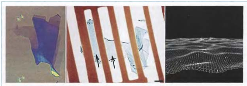
Рис. 2. На фотографиях (слева) показаны пленки графена, полученные на окисленной кремниевой подложке и на золотом каркасе. Модель искаженной графеновой пленки толщиной в один атом (справа)
