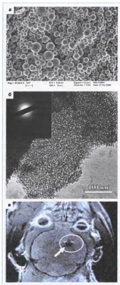
Рис. 1. Магнитные наночастицы внутри водорастворимых солевых капсул: а — внешний вид капсул, сканирующая электронная микроскопия, б — наночастицы после растворения в воде, просвечивающая электронная микроскопия, в — наночастицы в мозговой ткани мыши, магнитно-резонансная томография (ФНМ МГУ им. М.В. Ломоносова)
