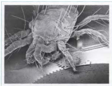
Рис. 2. Почти невидимый невооруженным глазом клещ с удивлением взирает на микроскопические шестеренки, изготовленные в МЭМС (Турция)
