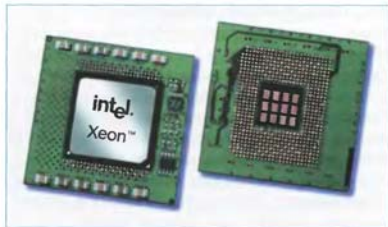
Современный процессор производства компании Intel. Размер элементов транзистора в таких процессорах менее 50 нм
