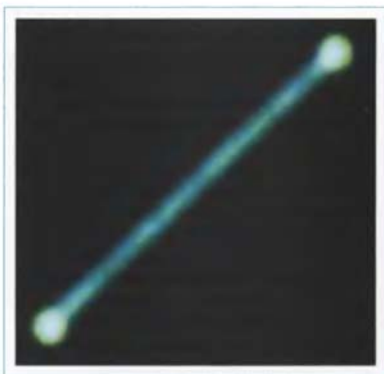
Рис. 2. Фотолюминесценция отдельного наностержня CdS
