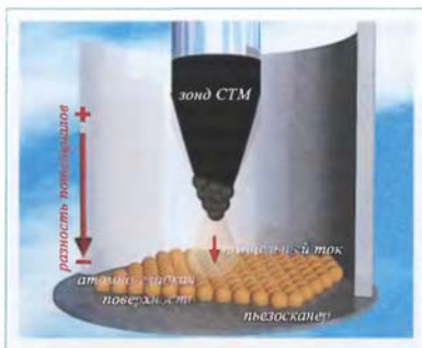
Схема метода сканирующей туннельной микроскопии
