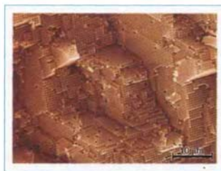
Рис. 1. Фотонный кристалл, аналогичный природному опалу. — образец состоит из упорядоченных сферических частиц размером около 650 нм (ФНМ МГУ им. М.В. Ломоносова)
