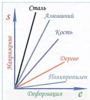
Рис. 1. Линейные части кривых деформирования материалов. Тангенс угла наклона — модуль упругости (модуль Юнга), обычно обозначается символом E
