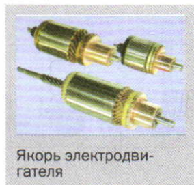
Рис. 119. Схема якоря двигателя
