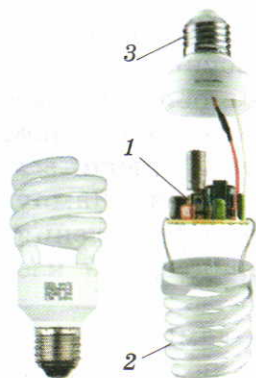
Рис. 88. Энергосберегающая лампа: 1 — электронный блок; 2 — стеклянная колба, покрытая люминофором; 3 — цоколь
